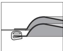
Dichtungsring auf die Kante der inneren Revisionsdeckel-Platine aufstecken, so dass sich die dickere Seite des Dichtungsringes zwischen den Revisionsdeckel-Platinen befindet.
