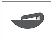
Der Kantenschutz SKK hat einen eingespritzten Schmelzkleber und kann bei Kanalwand-dicken bis zu 2 mm eingesetzt werden.
