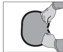
Die Kantenschutzenden sollten an einem geraden Teil des Ausschnitts zusammentreffen. Den Kantenschutz so abschneiden, dass die Enden satt unter leichtem Druck aneinander liegen, aber nicht überlappen!
