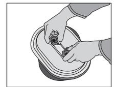
Die Drehgriffe bis Anschlag herausdrehen und den Deckel etwas verdreht in die Öffnung einschieben. Dann den Deckel gerade drehen, leicht herziehen und die Drehgriffe fest anziehen.
