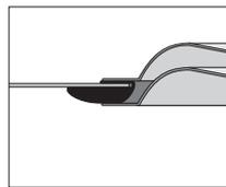
Der dicke Wulst des Kantenschutz-Profiles muss ins Kanalinnere. Den Kantenschutz so aufstecken, dass die Kanalwand möglichst tief eindringt.
