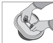
Die Drehgriffe bis Anschlag herausdrehen und den Deckel etwas verdreht in die Öffnung einschieben. Dann den Deckel gerade drehen, leicht herziehen und die Drehgriffe fest anziehen.
